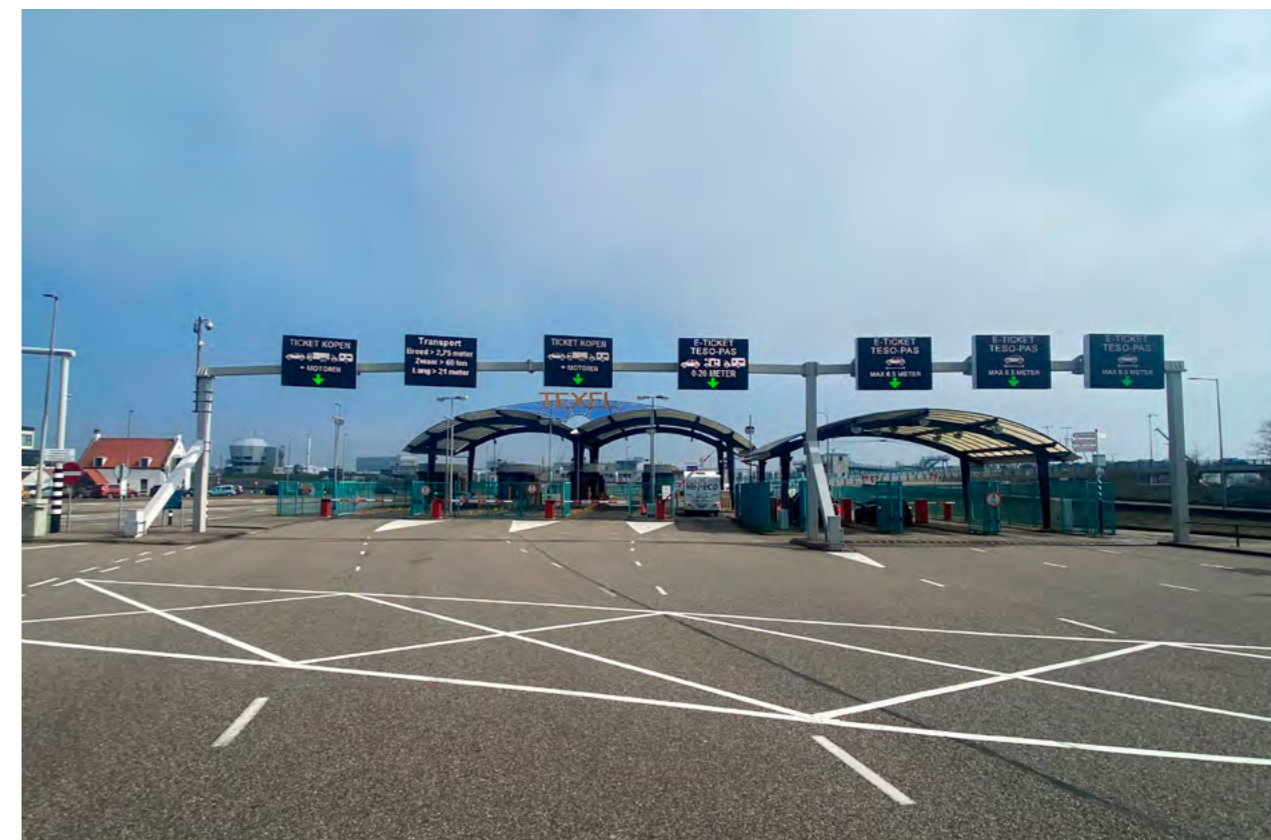
Extra slagbomen ten behoeve van automatische lengtemeetsysteem bij de voertuigloketten.
